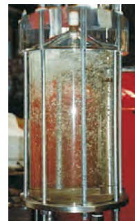
Bild 11: dynamische Vakuum-entgasung am 'servitec'-Versuchsstand
