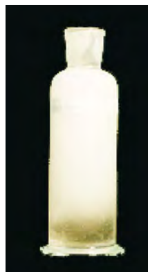
Bild 2: stickstoffübersättigtes, Heizungswasser nach der Probenahme
