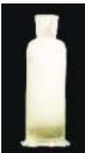
Bild 3: stickstoffübersättigtes, aber sauerstofffreies Heizungswasser nach der Probenentnahme
